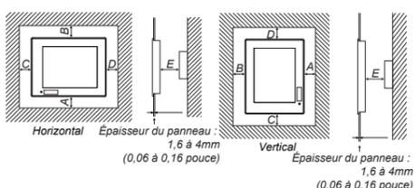
Laissez les espaces entre le GOT et les autres dispositifs en fonction des dimensions contenues dans le tableau suivant. Les valeurs entre parenthèses s'appliquent au cas où aucun dispositif générant des émissions sonores (comme un contacteur) ou de la chaleur n'est installé près du GOT.
